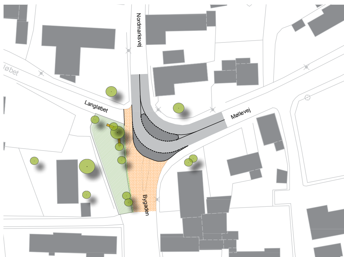
Omprioritering af vigepligt i krydset Bygaden/Møllevej/Nordmarksvej.
